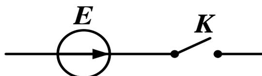
Lorsque l'échelon de tension alimente un circuit, il donne naissance dans ce circuit au régime transitoire appelé aussi "réponse à l'échelon de tension".
