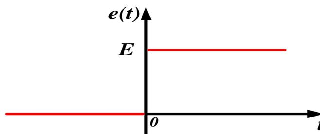
L'échelon de tension est réalisé en montant en série une  $f. \acute{e}. m.$  constante  $E$  et un interrupteur  $K$  que l'on ferme à  $t = t_0$
